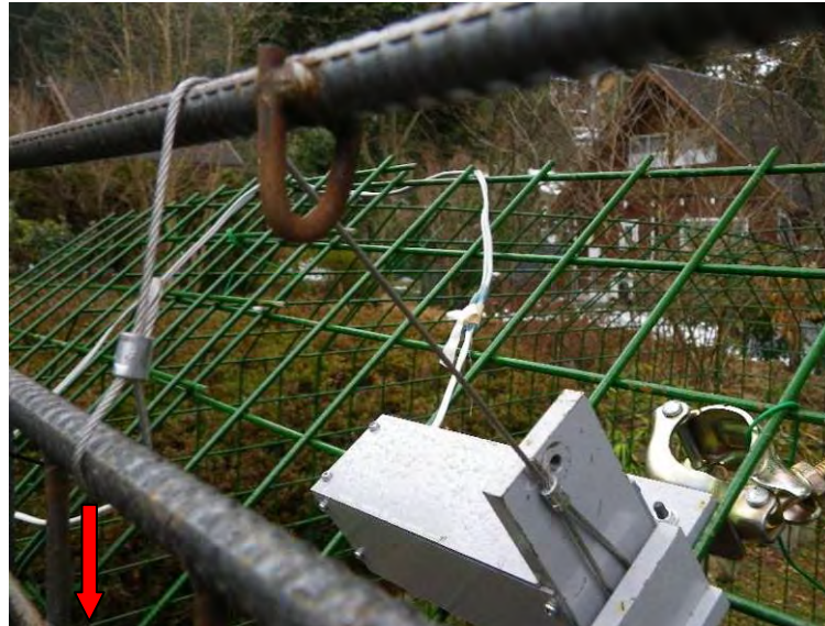
図5. ソレノイドを活用した電子トリガー 電子トリガーに電気信号を送ることでソレノイドを稼働させ、保持しているワイヤーをリリースする構造になっている。図中、赤矢印は、扉の落下方向を示している。
