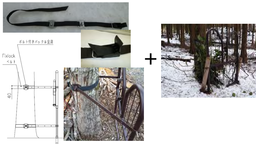
図5．専用ステー及びベルトによる固定（立木利用型）
