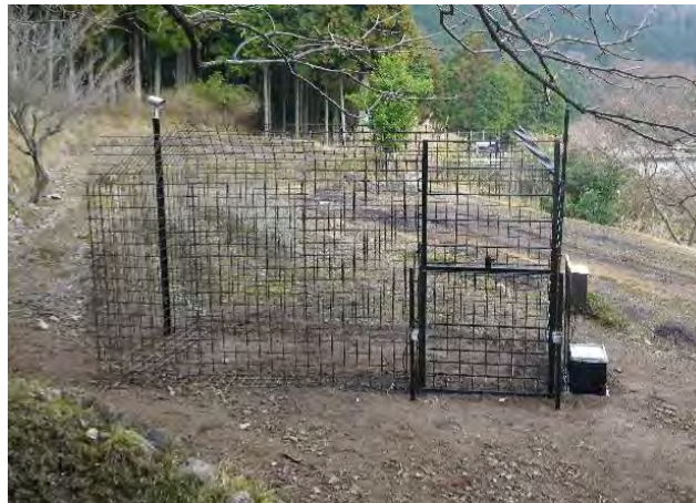
図 8. 試作、改良した組み立て式囲いわな (写真は、W2m×L4m×H2m、竹森鐵工社製)
