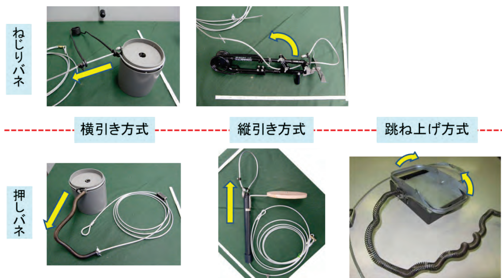
図 3. 今回、比較実験に使用した 5 種類のくくりわな
